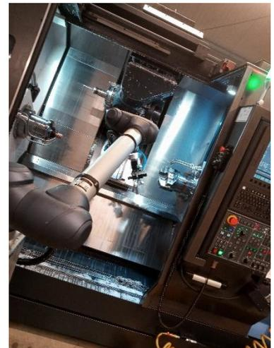
Abbildung 1: 7-Achs Multitasking Maschine Puma MX mit Roboterbestückung
