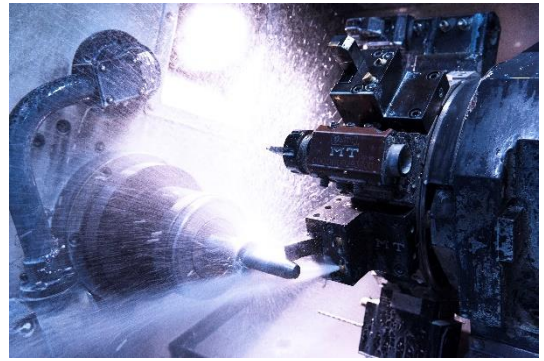
Abbildung 2: CNC_Drehmaschine beim Drehen eines Edelstahl-Bolzens
