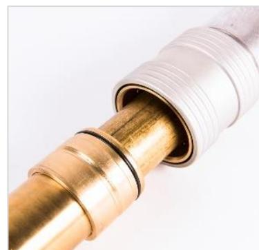
**DE** Der Schnellwechselfüller S2 zeichnet sich durch seine Vielseitigkeit ab und kann sowohl für EPS als auch für EPP eingesetzt werden. Die getrennte Ansteuerung von Füll- und Steuerluft sowie die optimierte Geometrie im Inneren des Füllers verringert die Gefahr von Materialstau. Der Füller besteht aus einer getrennten Hülse und einer Antriebseinheit. Die Hülse kann in der Form verbleiben, die Antriebseinheit wird durch eine Schnellkupplung gelöst und einfach herausgezogen.
